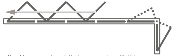
Naar binnen vouwbaar | Vantaux ouvrant vers l'intérieur
